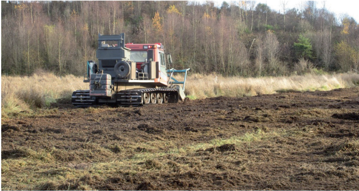
Fig. 4: Restoration mowing of fallow surfaces specifically for Whinchats and other wetland species. The project managed to restore approx. 45 ha of fallow land using specialised machinery, adapted for working in wetlands. - Erstpflegemahd auf jahrelang verbrachten Flächen. Auf insgesamt 45 Hektar Fläche konnten während des Projektes, mit Hilfe von spezialisierten landwirtschaftlichen Maschinen, verbuschte oder verbrachte Flächen gezielt für das Braunkehlchen restauriert werden (Photo: © natur&emwelt).
